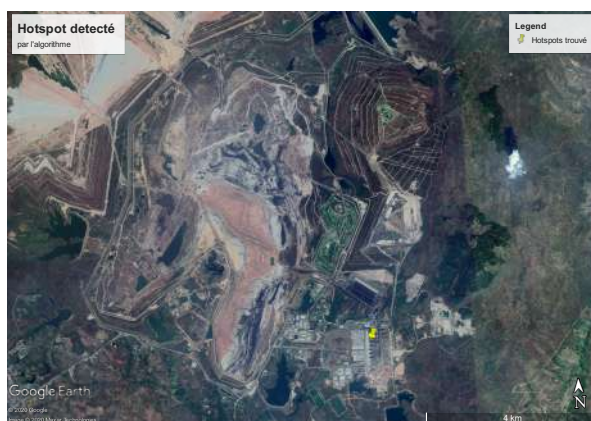
FIGURE 39 – Mine de lignite (à gauche) liée à une centrale elle aussi de lignite (en bas à droite) identifiée comme nouvelle source ponctuelle de \text{NH}_3 en Thaïlande.
